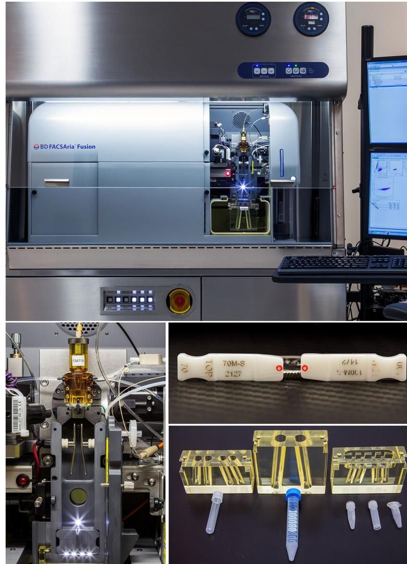
Le BD FACSAria Fusion est un trieur de cellules à grande vitesse à 20 paramètres, capable de détecter 18 couleurs ainsi que la diffusion avant et latérale. Sa cuvette couplée au gel permet des mesures de fluorescence très précises et sensibles, comparables à celles de notre LSR Fortessa.
